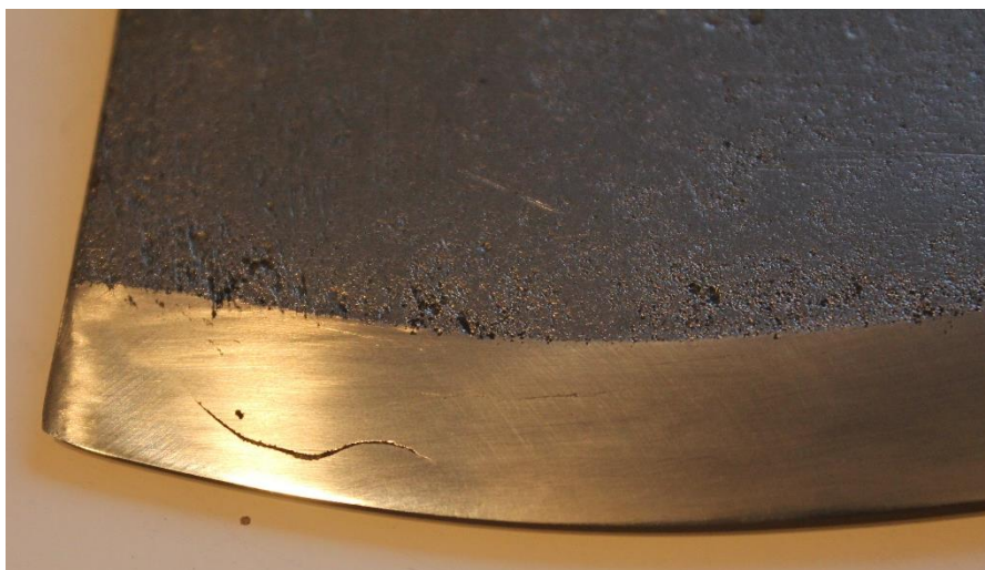
Figur 19 - Detalj av vällfog som inte vällts helt.
