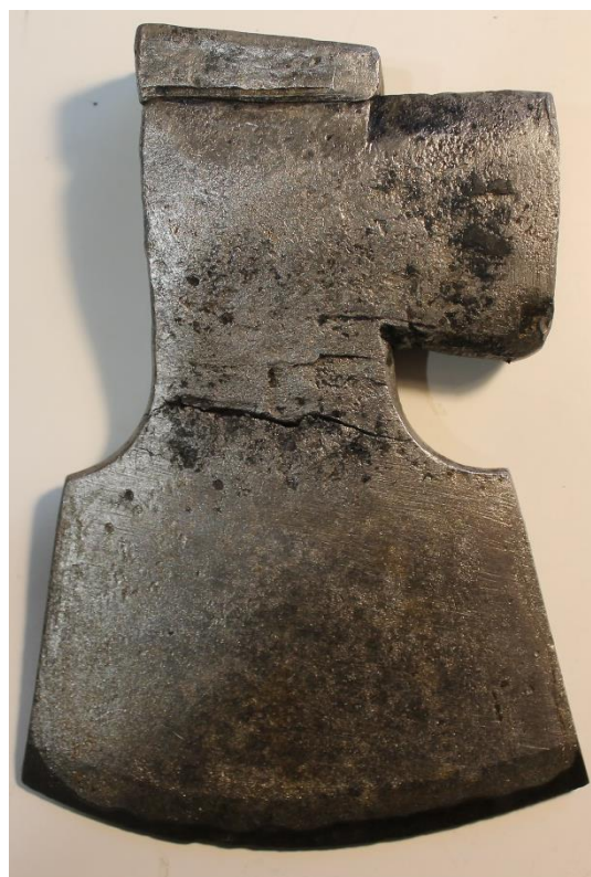
Figur 12 - Yxhuvudet efter stålborstning
