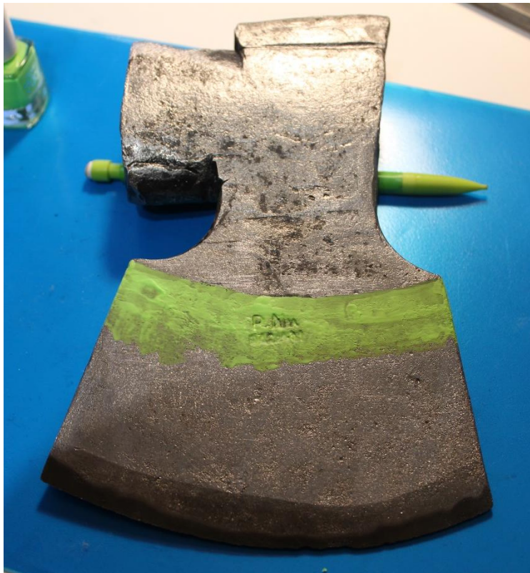
Figur 15 - Maskering av yxan med nagellack
