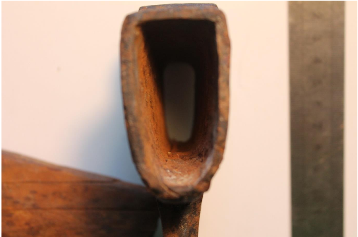
Figur 5 - Detalj av vällskarv inuti skaftholken
