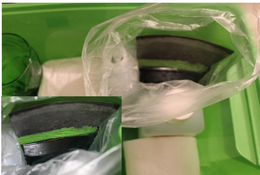
Figur 16 - Yxan i blåneringsvätska
