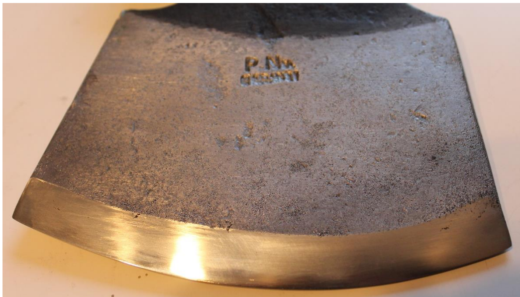
Figur 20 - Slipfasen efter att den slipats med den enkelhuggna flatfilen
