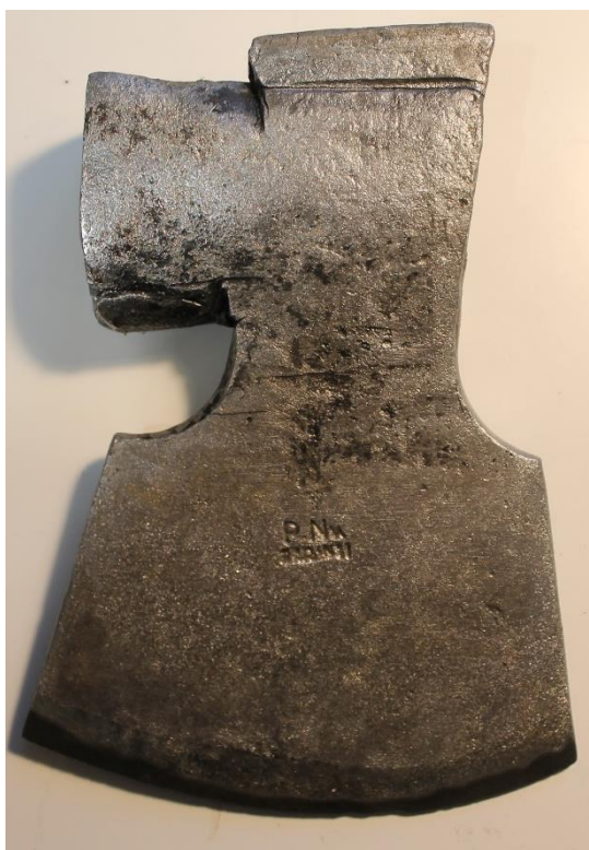
Figur 11 - Yxhuvudet efter stålborstning
