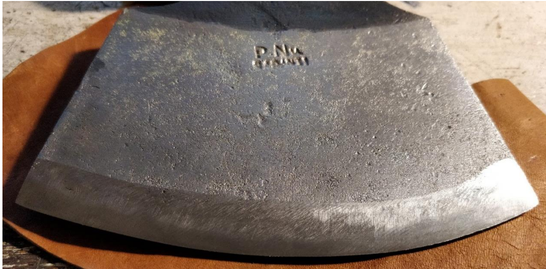
Figur 21 - Detalj av eggen efter slutlig strigling
