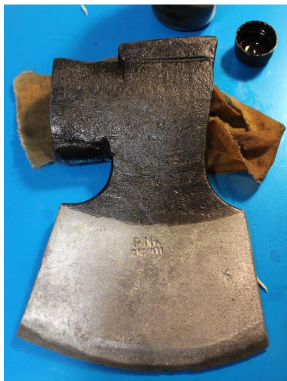
Figur 17 - Efter borttagning av nagellack och inoljning med roslagsmahogny
