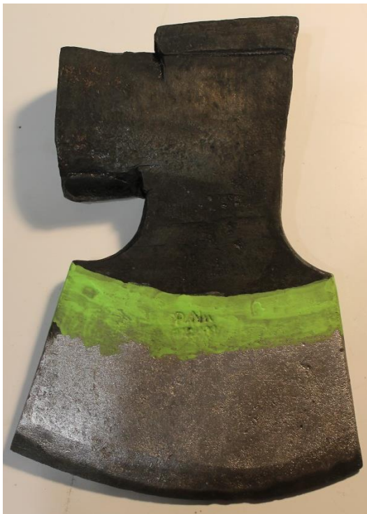
Figur 18 - Yxhuvudet efter blånering
